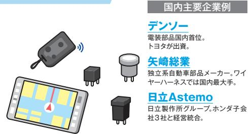
自動車に装備される電子機器類を総称して電装部品と呼ぶ。カーナビゲーションシステムやカーオーディオなどの映像・音響部品をはじめ、電子化されているエンジンコントローラユニットやフューエルインジェクションなどの内燃機関系部品、ワイヤーハーネスなどの電線も含まれる。
