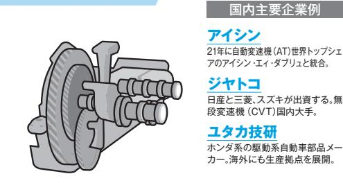
エンジンで発生したエネルギーを推進力に変換する動力伝達装置や、操縦系部品を総称して駆動系部品と呼ぶ。トランスミッションやデファレンシャルギヤ、ユニバーサルジョイント、サスペンション、ステアリングなどが代表的な部品であり、内燃機関と並ぶ主要パーツである。
